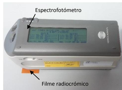
Figura 6: Medição das coordenadas cromáticas
