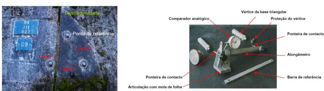
Figuras 1 e 2 – Base triangular para medição manual (à esq.ª) e alongâmetro e respetivos acessórios (à dir.ª)
